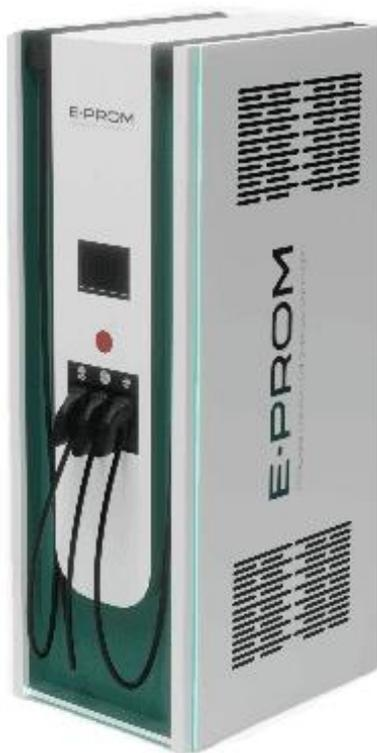
Зарядная станция электромобилей E-PROM 200 Premium с фирменным уникальным дизайном предназначена для заряда электротранспорта постоянным током мощностью до 200 кВт с применением трёх видов разъемов (CCS Combo 2, CHAdeMO, GB/T), с динамической балансировкой мощности (количество коннекторов может отличаться в зависимости от комплектации). Зарядная станция имеет модульную конструкцию, которая позволяет обеспечить удобную эксплуатацию и сервисное обслуживание.
